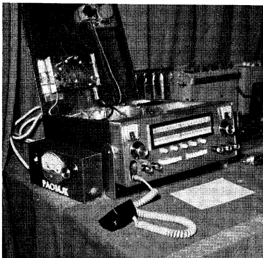
Dit is de geheel getransistoriseerde 2 m zendontvanger van PAoMJK. Het toestel is geschikt voor AM, FM en EZB. MJK won hiermee de vierde prijs.
